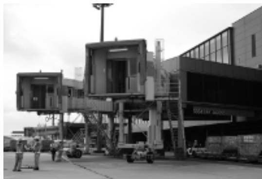
図7-10 パッセンジャー・ボーディング・ブリッジ 航空機との接続部
