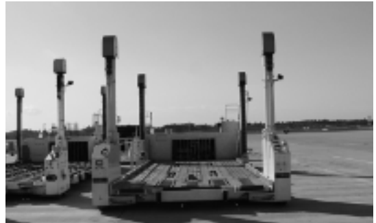
図7-13 メイン・デッキ・ローダー
