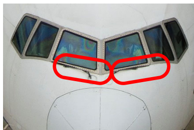
ず なか 図11 WindshieldとWiper (○の中)
