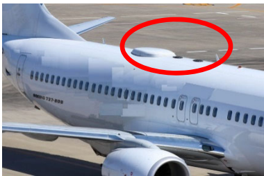
図10 衛星通信 (SATCOM) のアンテナ (Antenna) 部分
